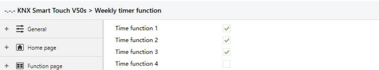
图 5.6 “Weekly timer function”参数设置界面
